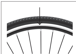
Obr. 2: Kontrolní drážka stavu opotřebení na ráfku.
